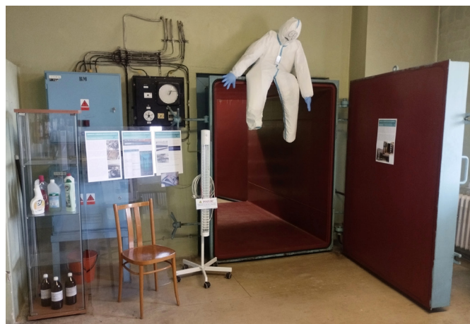
Obr. 4. Etylénoxidová komora slúžiaca na sterilizáciu dokumentov a germicídny žiarič používaný na dezinfekciu vzduchu a prostredia. Foto: Zuzana Sihelníková.
